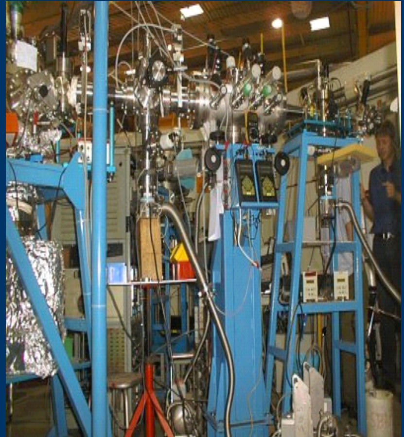
La ligne de lumière synchrotron SU-5 du LURE (Orsay) où les échantillons d'acides aminés ont été irradiés induisant une asymétrie à l'état solide. On distingue à gauche la cellule d'irradiation et au centre le polarimètre permettant de calibrer la polarisation du rayonnement UV lointain.
